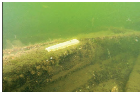
Fig. 4. Kölsvinet med masthålet. Kölsvinet ligger på sidan rubbat ur sitt rätta läge. Foto: Marcus Hjulhammar, Sjöhistoriska museet.
