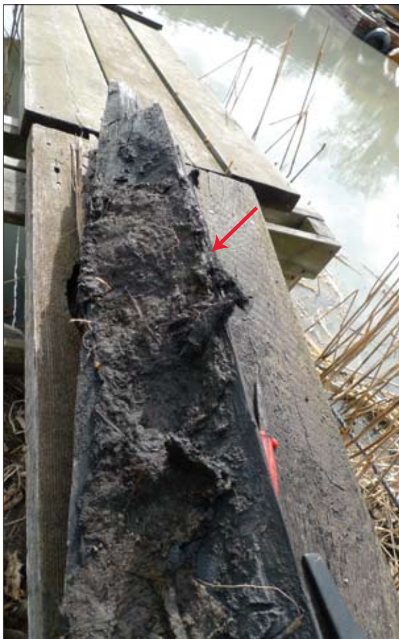
Fig. 4. Kölen sedd mot akterstävets lask. Notera den kraftiga lagningen ovanpå kölen (röd pil).
